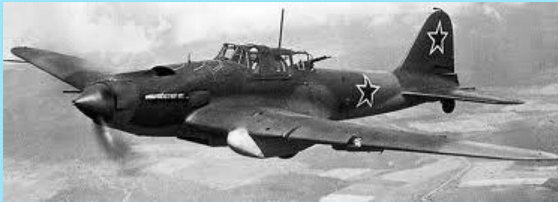
Штурмовик Ил-2 разработан в ЦКБ-57 под руководством Сергея Ильюшина. Это была машина, специализированная для атаки наземных целей с малой высоты. Главная особенность конструкции – применение несущего бронекорпуса, закрывавшего летчика и жизненно важные органы самолета. Броня Ил-2 не просто защищала от малокалиберных снарядов и пуль, но и служила частью силовой конструкции фюзеляжа, за счет чего удавалось достичь ощутимой экономии массы.
